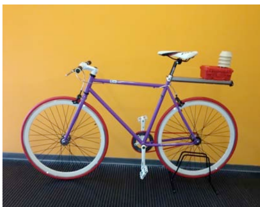
Figura 3 - La SmartBox montata su una Bicicletta
